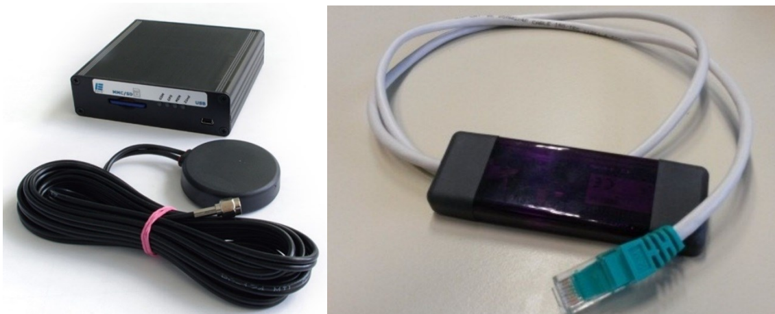
Abbildung 4: GPS-Datenlogger und Bluetooth-Datenübertragungsmodul
